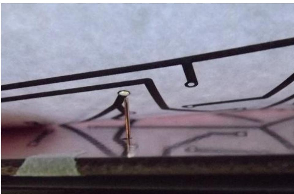
Figura 23 - Detalhe do encaixe entre o marcador e a folha de papel Glossy contendo o novo circuito impresso a ser fixado.
