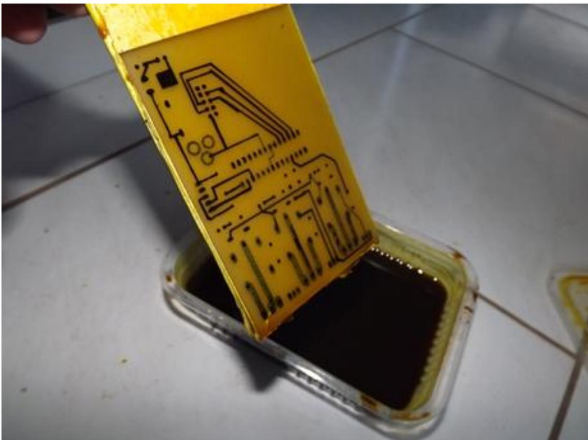
Figura 20 - Placa de circuito impresso corroída.
