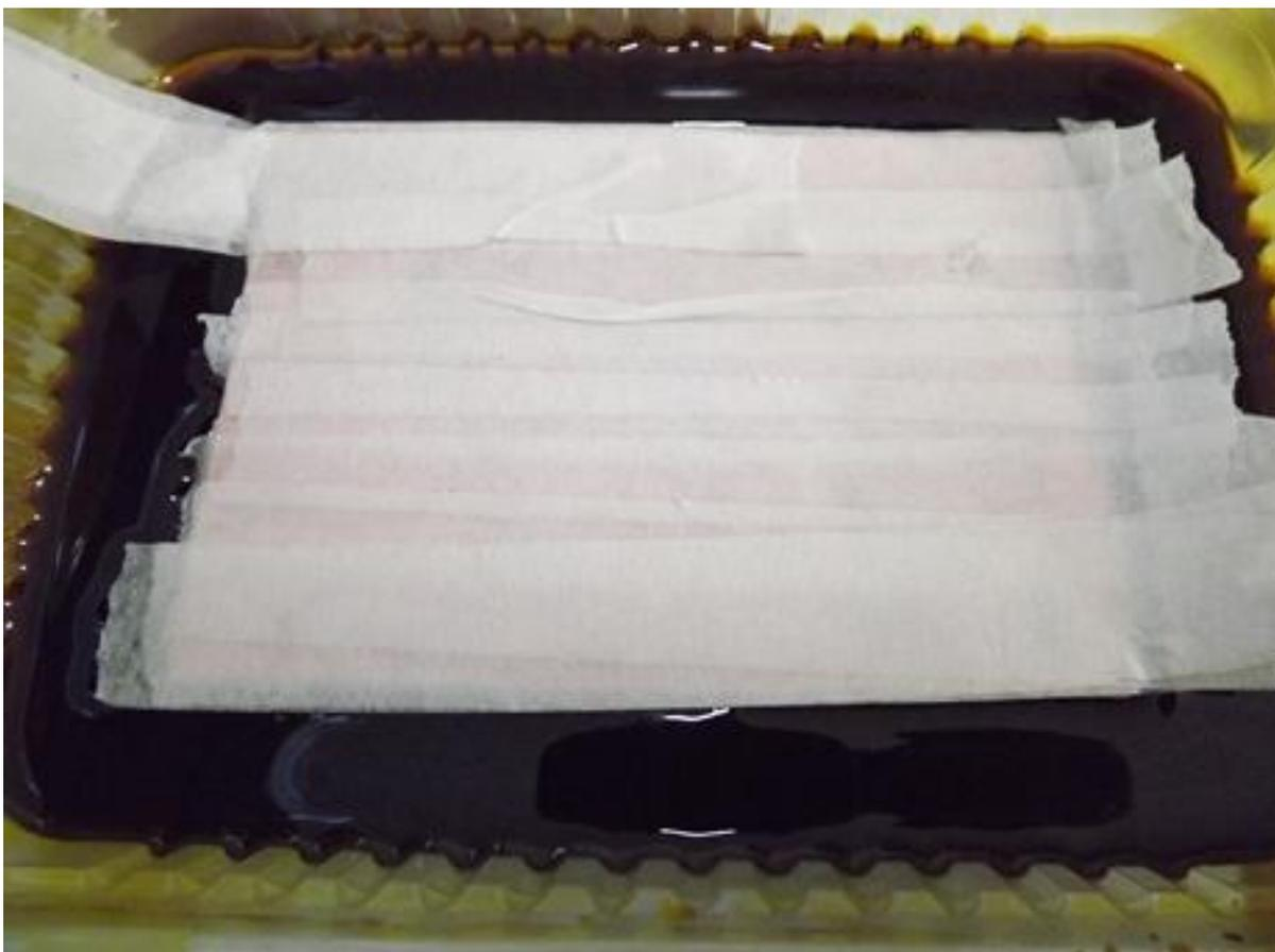
Figura 19 - Recipiente de plástico com a solução de percloroeto de ferro e a placa de circuito impresso.
